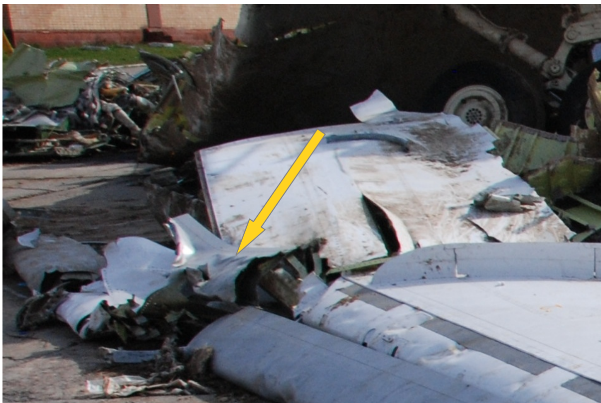
Powiększony kadr ze zdjęcia DSC_0175, wykonanego przez członków KBWLLP 19.04.2010 – widoczne wyraźnie wygięcie uszkodzonej w wyniku zderzenia części z poszarpanym i zdeformowanym przekrojem.
